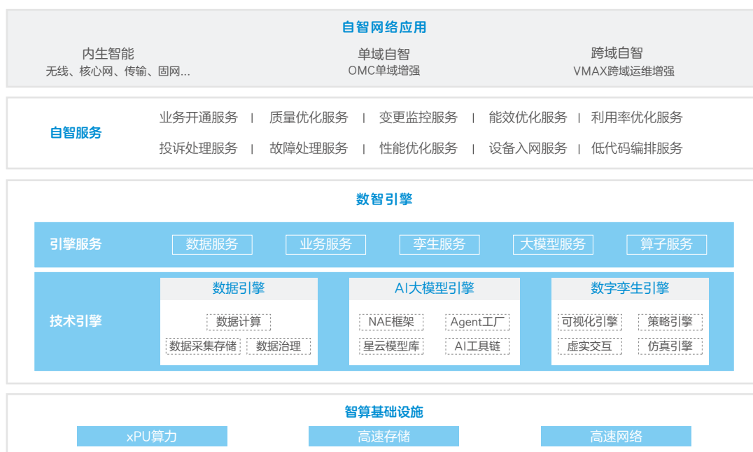
图08 中兴AIR Net技术架构图
